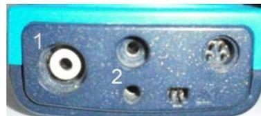
*Abb. 2 Anschlüsse eine pH-Handgerätes
