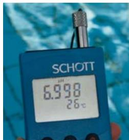
Abb.8 Auflösung der Anzeige  $\Delta\text{pH} = 0,001$ .
