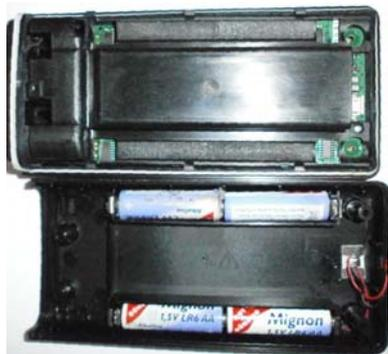
Abb.5 Das Innere eines pH-Handgerätes
